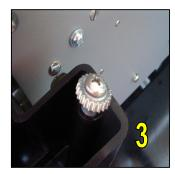
**5.3 INSERIMENTO DEL ROTOLO DI CARTA.** Per l'inserimento del rotolo di carta gommata : centrare le guide del rotolo nell'alloggiamento, lasciando un gioco sufficiente. Introdurre il rotolo aprendo il coperchio posteriore. Svolgere il nastro per ca. 30/40 cm. e farlo passare sotto i due perni, poi, aprendo il coperchio anteriore, sotto l'apposita piastra di guida, come si vede nell'img.5 con il lato gommato rivolto verso il basso. Chiudere il coperchio grigio della macchina,
