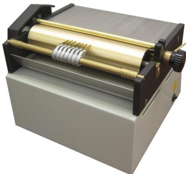
Il cilindro incollatore, in continua rotazione, mantiene un costante velo di colla, consentendo una gommatura perfetta e la massima pulizia dell'etichetta. Un apposito dispositivo permette la regolazione micrometrica della colla. E' costruita in acciaio inox ed alluminio ed ottone. Tutte le parti a contatto con la colla si smontano senza utensili, con il solo uso delle mani, rendendo facile e rapida la pulizia al termine del lavoro.
